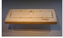
Stecken Sie die LEDs in die vorgesehenen Bohrungen. Zur Sicherheit drücken Sie mit einem kleinen Schraubendreher etwas an, bis die LEDs am Acryl anschlagen, somit ist die optimale Einbautiefe gegeben.
