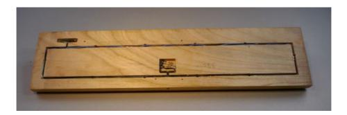
Stecken Sie die Versorgungsleitung durch das Loch und verlöten Sie entsprechend auch mit Schrumpfschlauch
